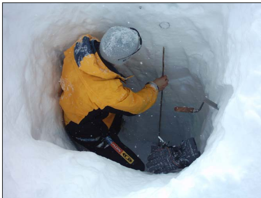
Abb. N.4: Schneeprofilaufnahme am 28. Januar 2004 (Archiv Olefs & Leichtfried)
