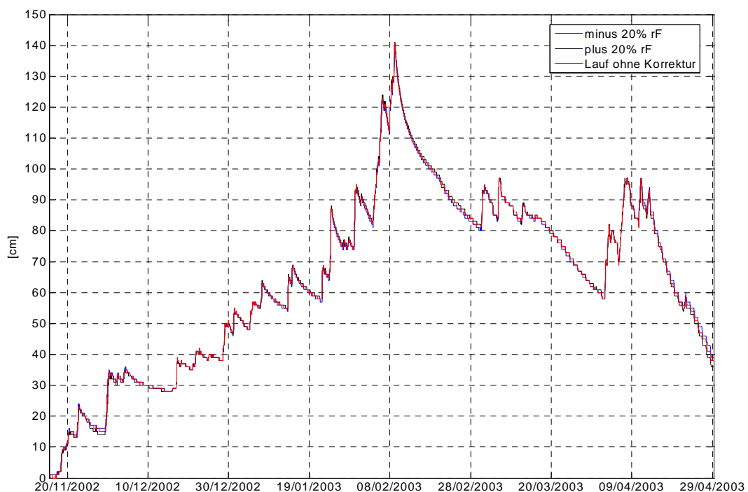
Abb. 6.4: Modellierte Schneehöhen mit Korrekturen in der relativen Luftfeuchte
