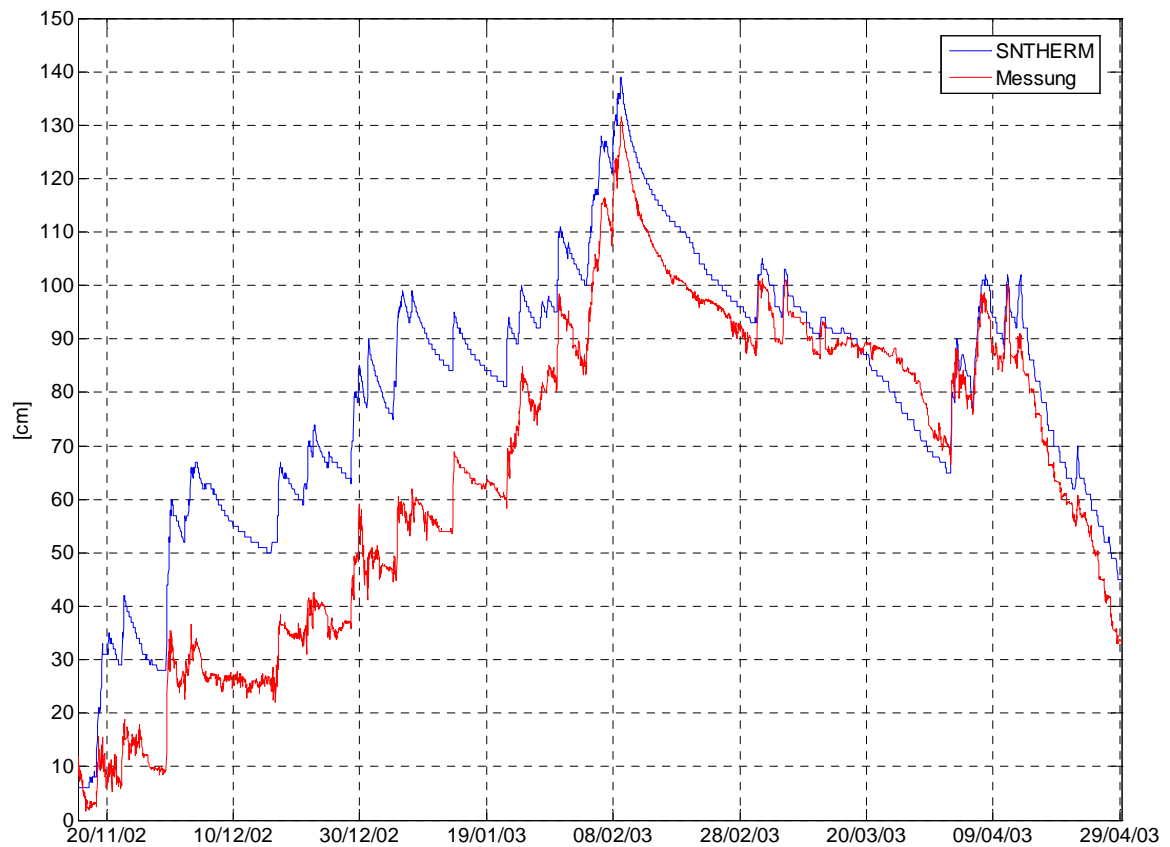
Abb. 5.2: Schneehöhen mit Optimierungsmaßnahmen für die Ablationsperiode
