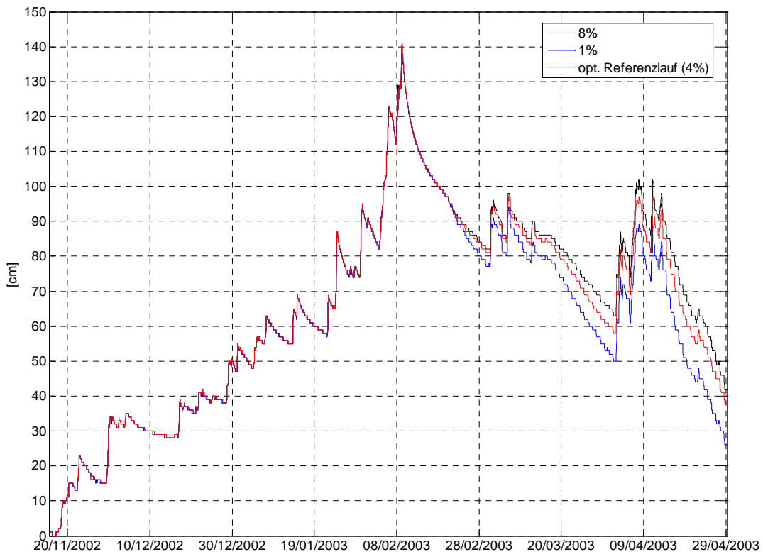
Abb. 6.13: Modellierte Schneehöhen mit Änderung des maximal möglichen Wassergehalts
