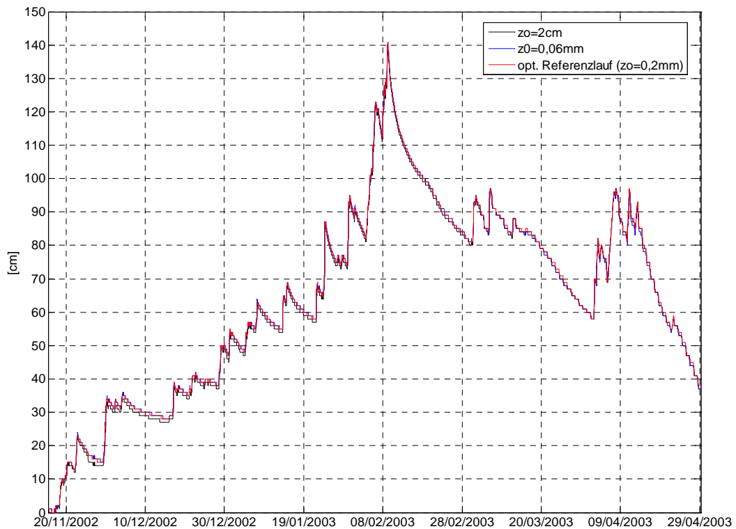
Abb. 6.12: Modellierte Schneehöhen mit Änderung der Rauigkeitslänge
