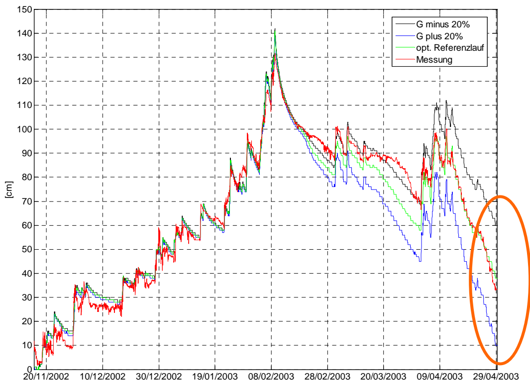
Abb. 6.6: Modellierte Schneehöhen mit Änderung der Globalstrahlung
