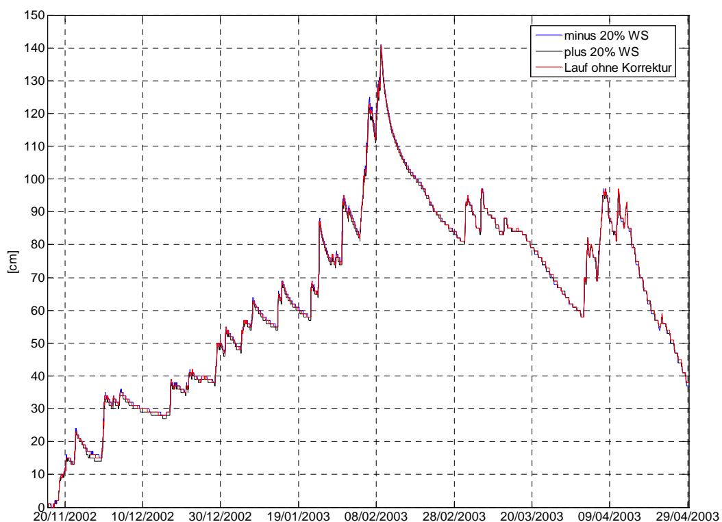
Abb. 6.8: Modellierte Schneehöhen mit Änderung der Windgeschwindigkeit
