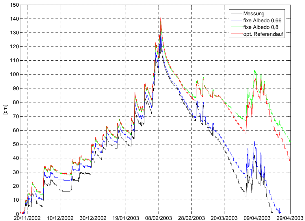
Abb. 6.16: Modellierte Schneehöhen mit verschiedenen Einstellungen der Albedo
