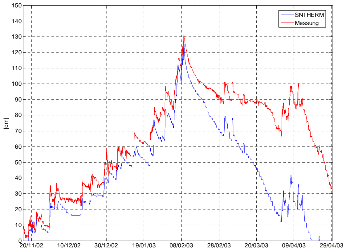
Abb. 5.1: Schneehöhen mit Optimierungsmaßnahmen für die Akkumulationsperiode
